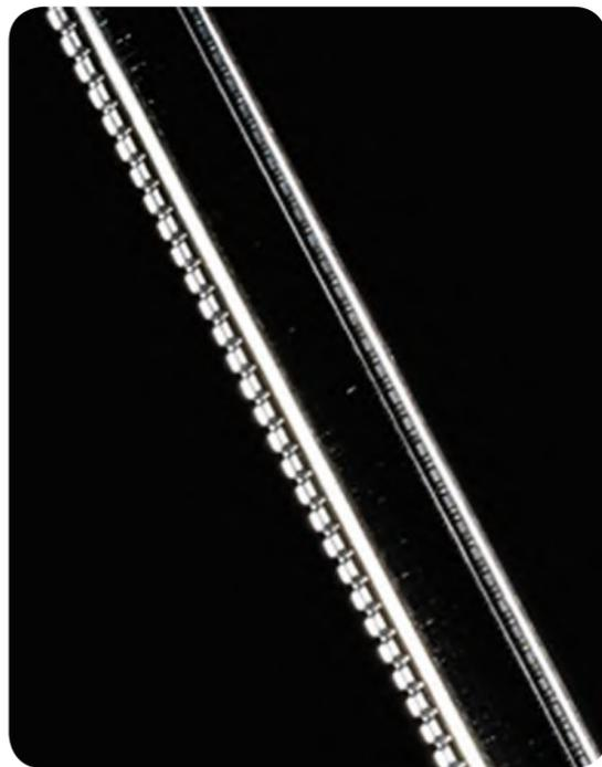
• *ENGEL ha desarrollado un nuevo proceso de plastificación específico para el procesamiento de PMMA que garantiza una alta eficiencia luminosa, también para estructuras LED largas, realizado con una máquina de moldeo por inyección ENGEL victory.*
