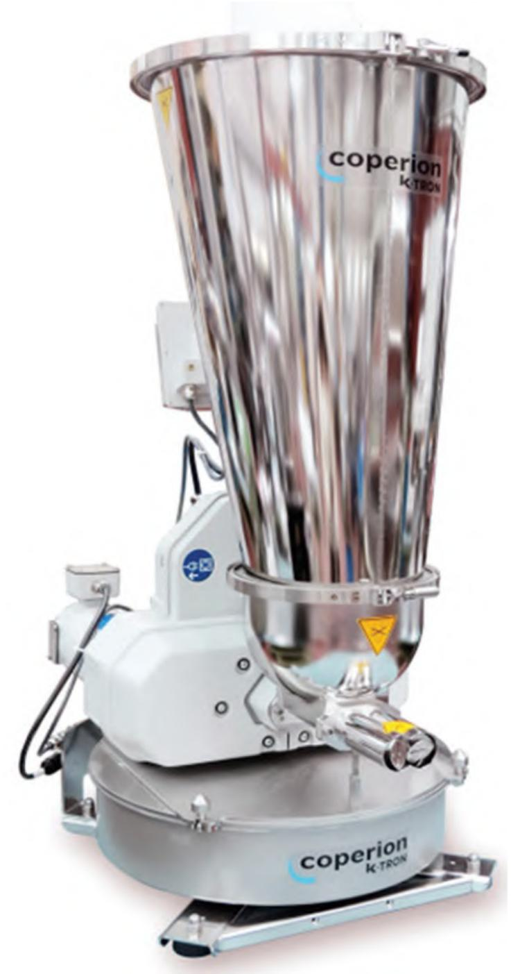
• El alimentador gravimétrico de cambio rápido K-Tron K2-ML-D5-T35 de Coperion ofrece una alimentación fiable y de alta precisión con la máxima flexibilidad. Fotografía: Coperion K-Tron, Suiza
