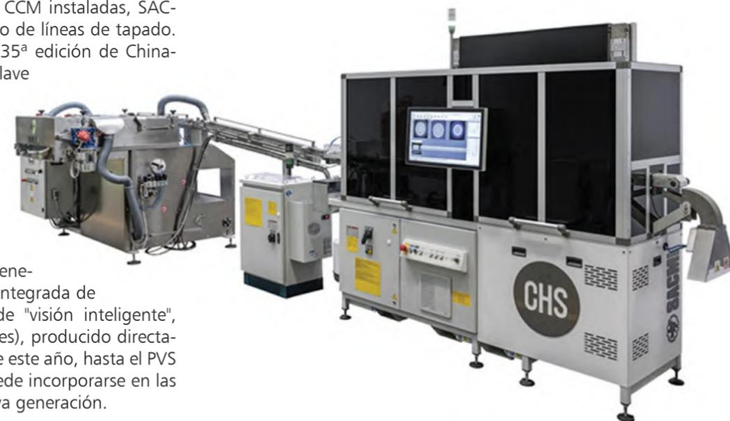
La gama de prensas se beneficia ahora de una gama integrada de sistemas de inspección de "visión inteligente", desde el CHS (para tapones), producido directamente en China a partir de este año, hasta el PVS (para preformas), que puede incorporarse en las IPS 300 e IPS 400 de nueva generación.
