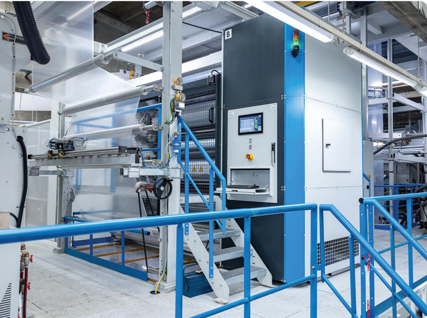
Con las películas de laminado y laminado con barrera de oxígeno en diseño de PE completo producidas por la línea de 7 capas con MDO en línea de Hosokawa Alpine, ManuliTech ofrece soluciones para envases de plástico reciclables.
