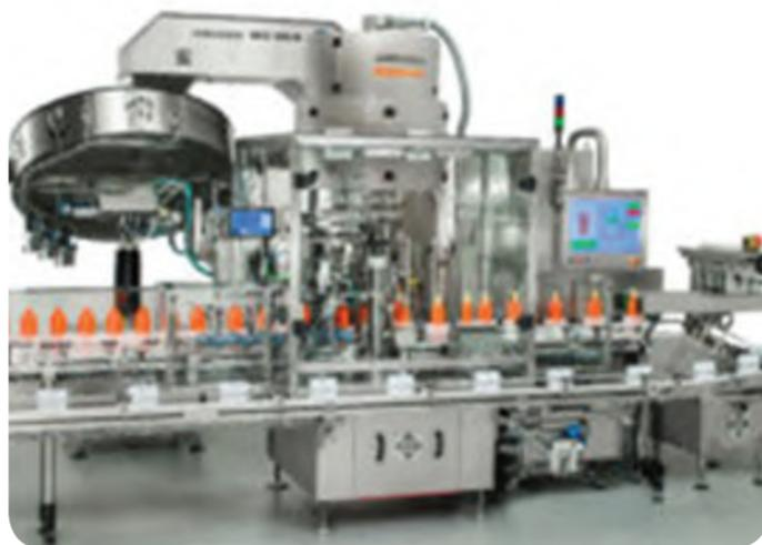
• La instalación de llenado Robomat, combinada con una máquina taponadora, coloca automáticamente los más diversos tipos de cierres en los frascos de cosméticos llenados previamente.
