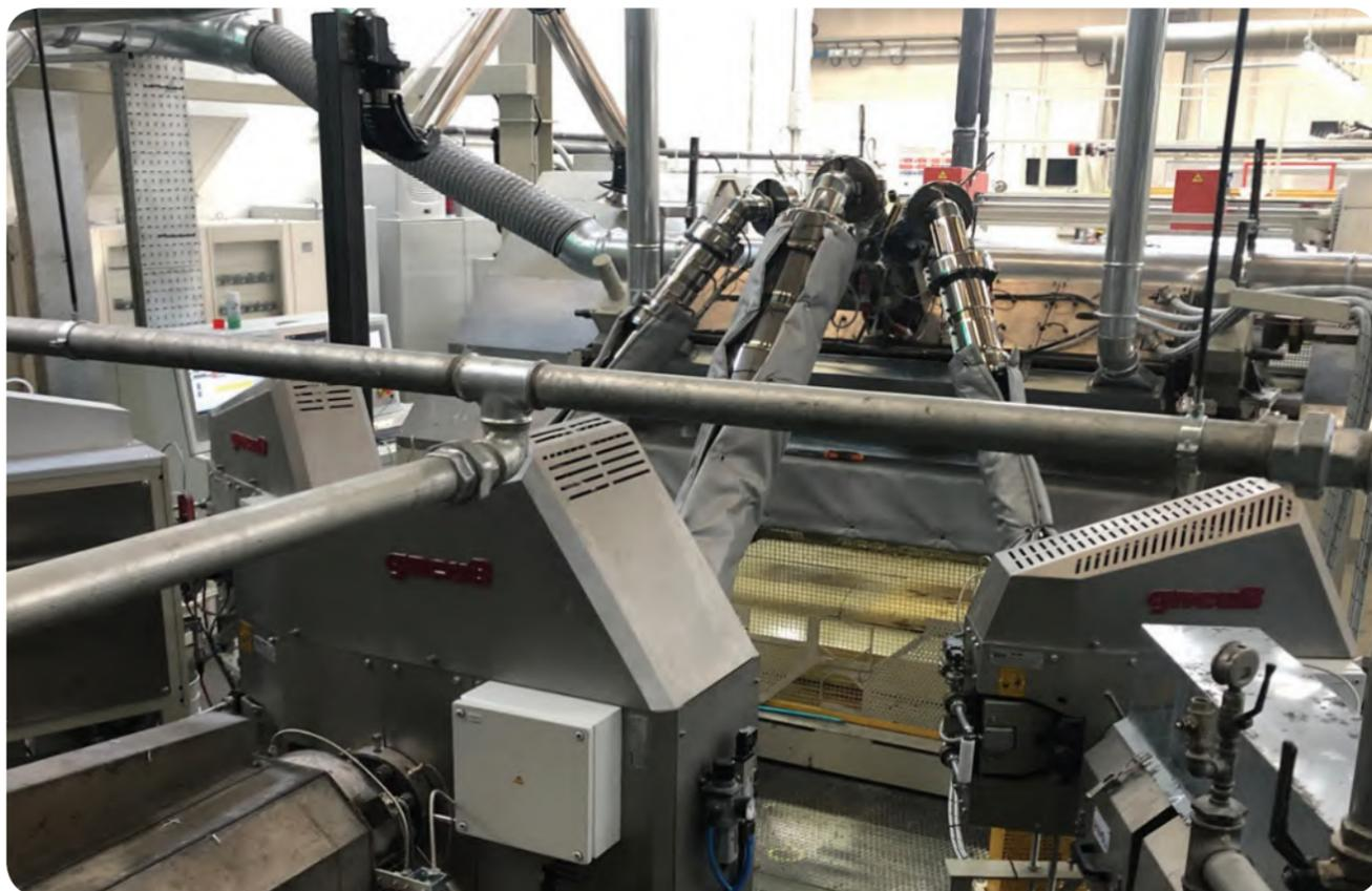
• Línea de extrusión de láminas en MP3 con tres filtros de fusión Gneuss SFXmagnus de presión y proceso constantes
