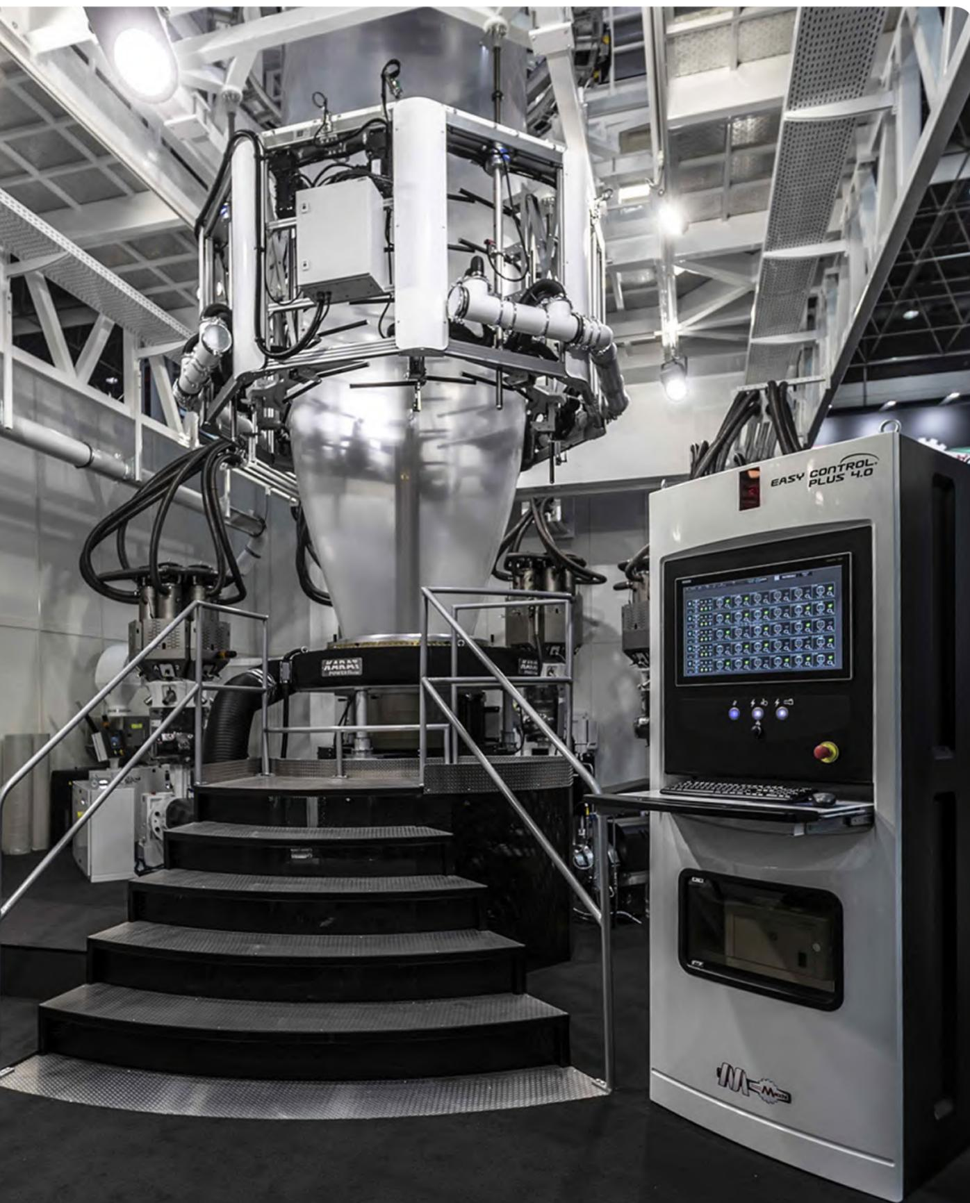
3 y 5 Capas, hasta 1.200 kg/h de producción máxima y hasta 3.600 mm de ancho.
