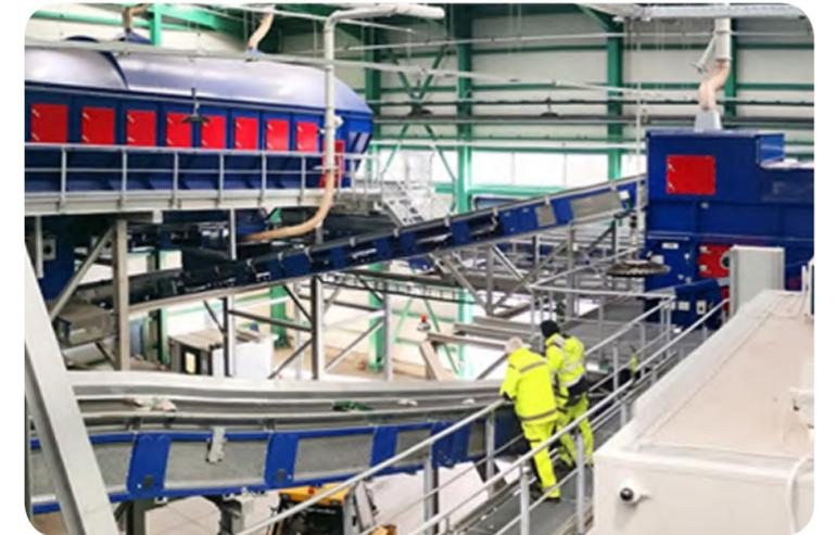
La planta de clasificación recibe residuos sólidos urbanos (RSU) mixtos con una capacidad de 30 a 40 Tn/h en una única línea. Se procesan para obtener una producción de materiales reciclados y material orgánico de alta calidad. Los primeros (envases de PET, PEAD, PP/PS, film, papel, cartón y latas de material ferroso y no ferroso (AL)) se clasifican de forma automática, separándolos en contenedores y después se embalan.
