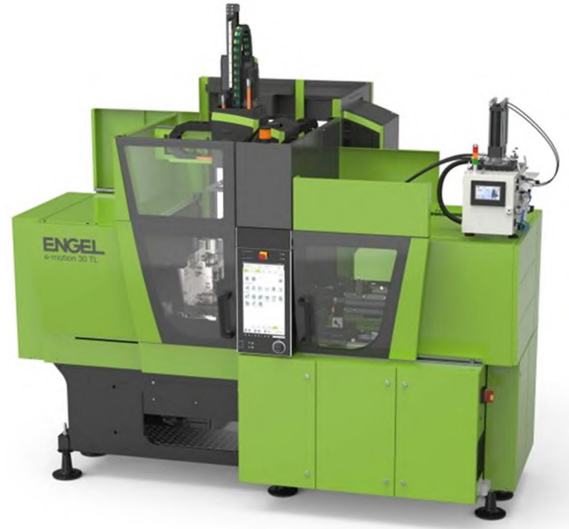
*En un espacio reducido: la máquina de moldeo por inyección e-motion TL totalmente eléctrica y sin columnas con un robot viper compacto e integrado.*
