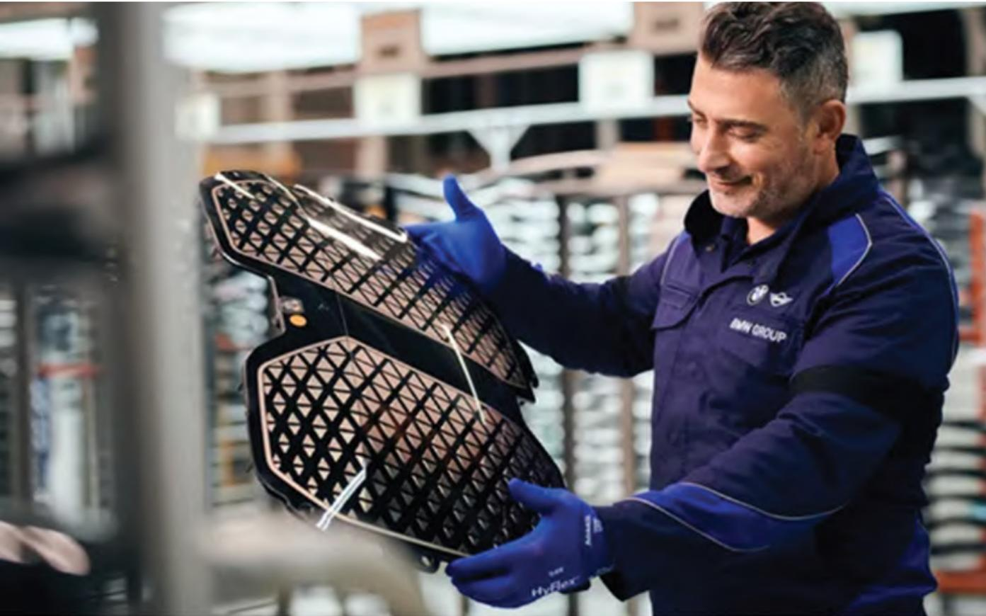
• Las parrillas tipo riñón del nuevo BMW ix se produce dentro de una celda de producción ENGEL altamente integrada en un cuarto limpio. Es la primera vez que la inyección trasera de película, combinada con el recubrimiento de poliuretano, se aplica a la producción en serie de un elemento para el complejo exterior de un vehículo. (Imagen: Grupo BMW)
