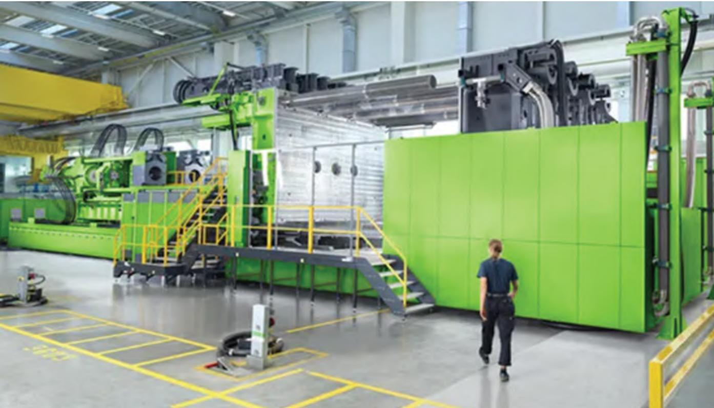
• Para las nuevas aplicaciones en movilidad se precisan, en ocasiones, máquinas de moldeo por inyección particularmente grandes. ENGEL construye megamáquinas con fuerzas de cierre de más de 10.000 toneladas. (Imagen: ENGEL)
