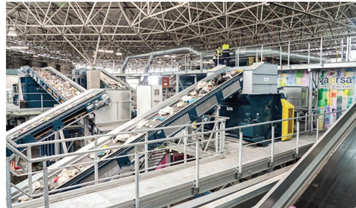
El diseño de STADLER para la nueva planta automatiza el proceso de clasificación con dos cabinas de clasificación, dos separadores balísticos STADLER STT2000 que separan los materiales flexibles 2D y 3D, separadores magnéticos y de Foucault que clasifican los metales en férricos y no férricos, y clasificadores ópticos que recuperan los materiales de reciclaje.
