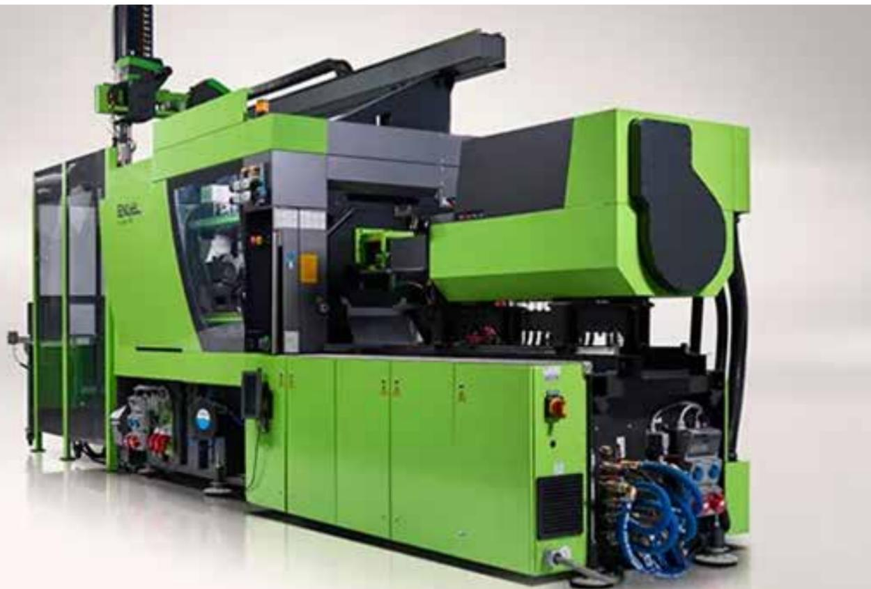
32 válvulas de infusión de silicona líquida, ranuradas en el proceso, se fabrican en una e-mac I30 totalmente eléctrica. Esto elimina la necesidad de cualquier retrabajo.
