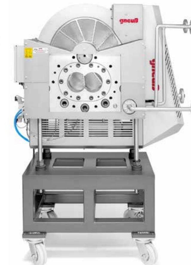
tarse con precisión a la extrusora de doble husillo, con recorridos de flujo extremadamente cortos y reológicamente optimizados, diseñados con la ayuda de un programa informático de simulación de flujos.
