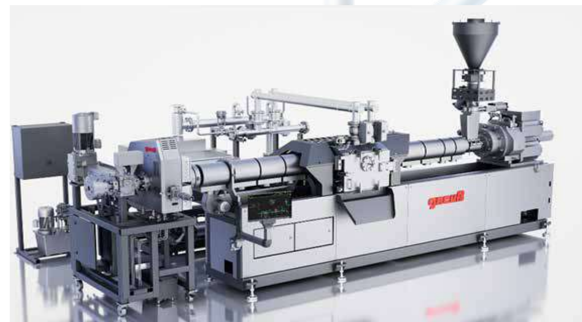
• Línea de reciclaje OMNI MRS I 10 con RSFgenius 90 y sistema de vacío que se exhibirá en la feria K antes de su envío a Argentina para la producción de láminas de R-PET y PP de grado alimenticio.
