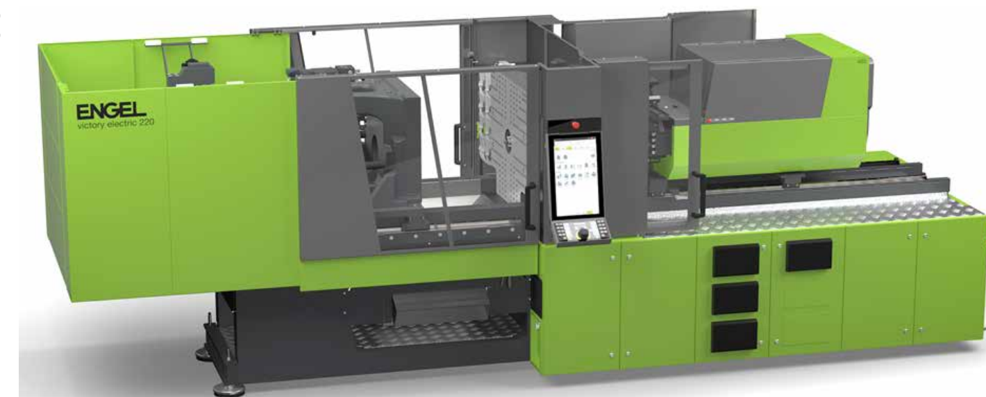
Más espacio de molde, menor espacio de apoyo: la nueva ENGEL victory electric 220 eléctrica con una fuerza de cierre de 2200 kN permite una producción compacta gracias a su diseño sin columnas y a su reducida longitud de máquina
