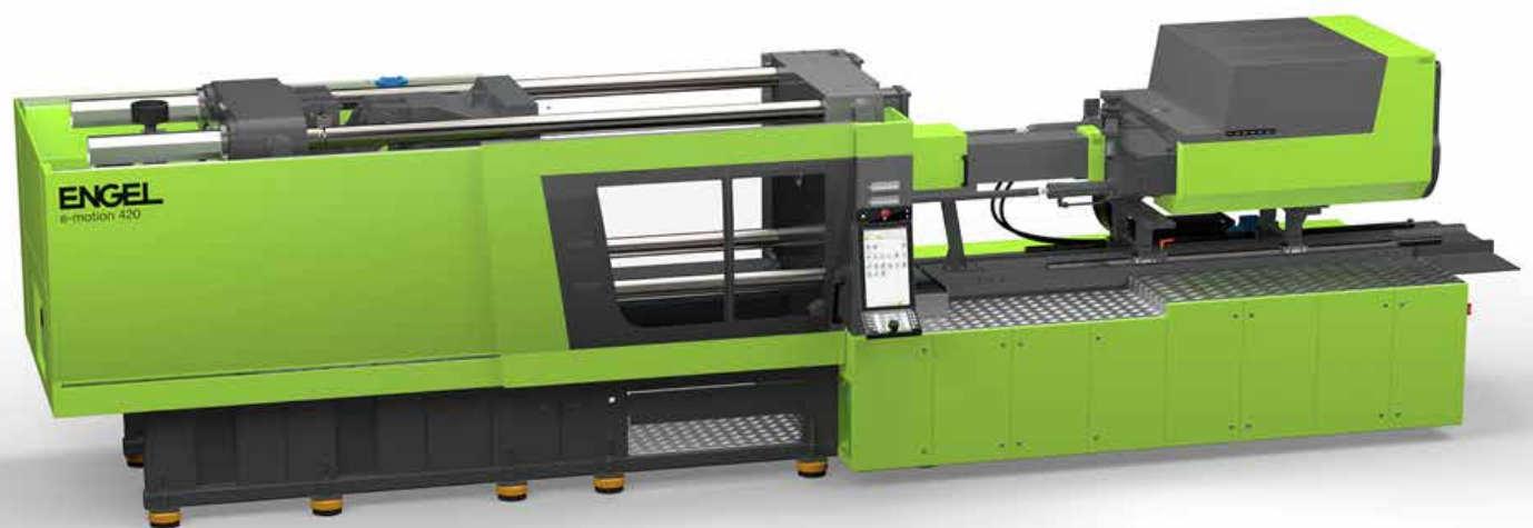
Nuevo ENGEL e-flojo one en funcionamiento en una ENGEL e-motion 420, consiguiendo una reducción de hasta el 50 % en el consumo de agua de refrigeración
