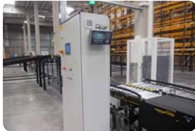
● armario de control, controlador de peso dinámico y control de calidad
