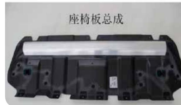
El conjunto de piso trasero de fibra de carbono se utiliza en vehículos eléctricos (BEV) y vehículos eléctricos híbridos (HEV) o vehículos eléctricos híbridos enchufables (PHEV), lo que puede mejorar significativamente la rigidez torsional del vehículo. Lugar de producción: Langfang, provincia de Hebei, China.
