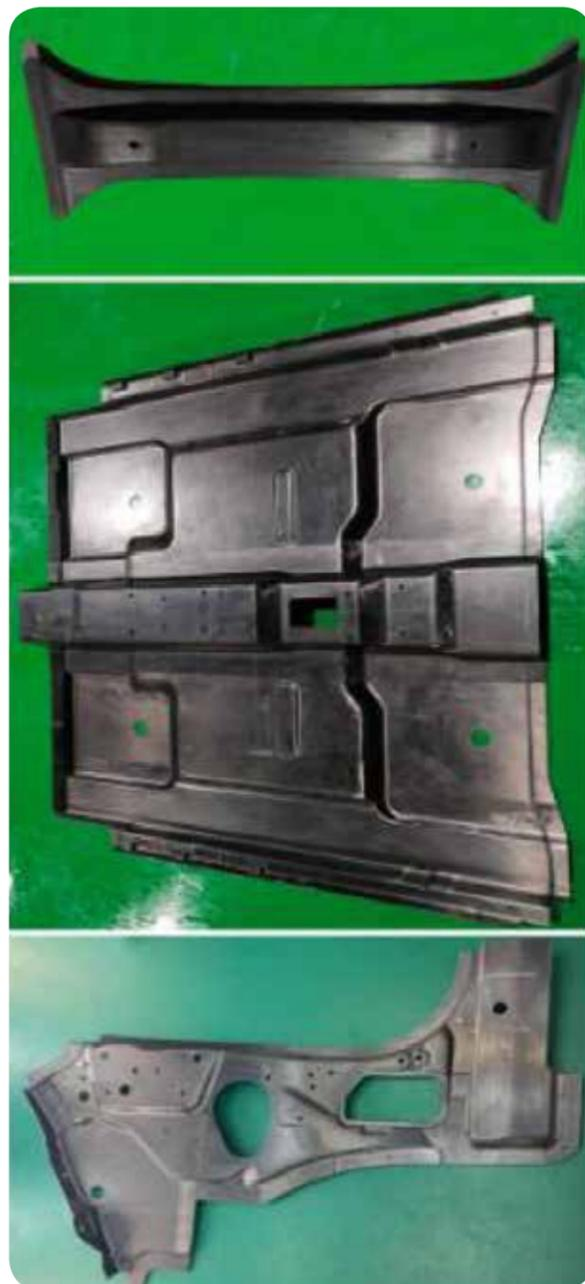
3. El rendimiento de la placa interior del pilar A se optimiza mediante la capa de refuerzo local, la tasa de reducción de peso alcanza el 52% y el ciclo de moldeo alcanza los 4,7 min / pieza mediante el proceso HP-RTM, que se encuentra en el nivel doméstico de primera clase.
