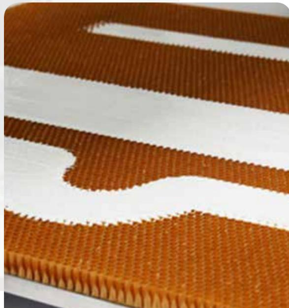
Una solución completa inteligente y totalmente automatizada para la producción de nido de abeja en la industria aeroespacial reduce el peso del producto final, reduce significativamente el trabajo y el consumo de material, y proporciona resultados de dispensación consistentes y repetibles.
