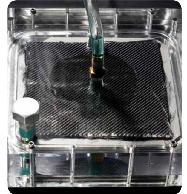
Los ingenieros de Nissan desarrollaron técnicas para simular con precisión la permeabilidad de la resina en la fibra de carbono, mientras visualizaban el comportamiento del flujo de resina en un troquel utilizando un sensor de temperatura en el troquel y un troquel transparente. El resultado de la simulación exitosa fue un componente de alta calidad con un tiempo de desarrollo más corto.
