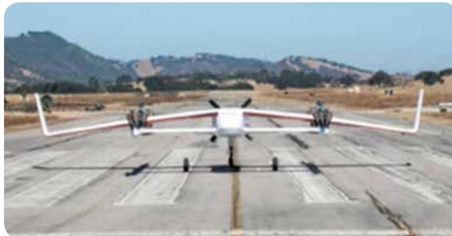
taforma Chaparral de Elroy Air es la única que cuenta con sistemas especializados para la carga, incluida una cadena cinemática híbrida-eléctrica que permite realizar entregas de largo alcance, y una manipulación automatizada de la carga para una carga y descarga rápida y desatendida. Estos desarrollos
