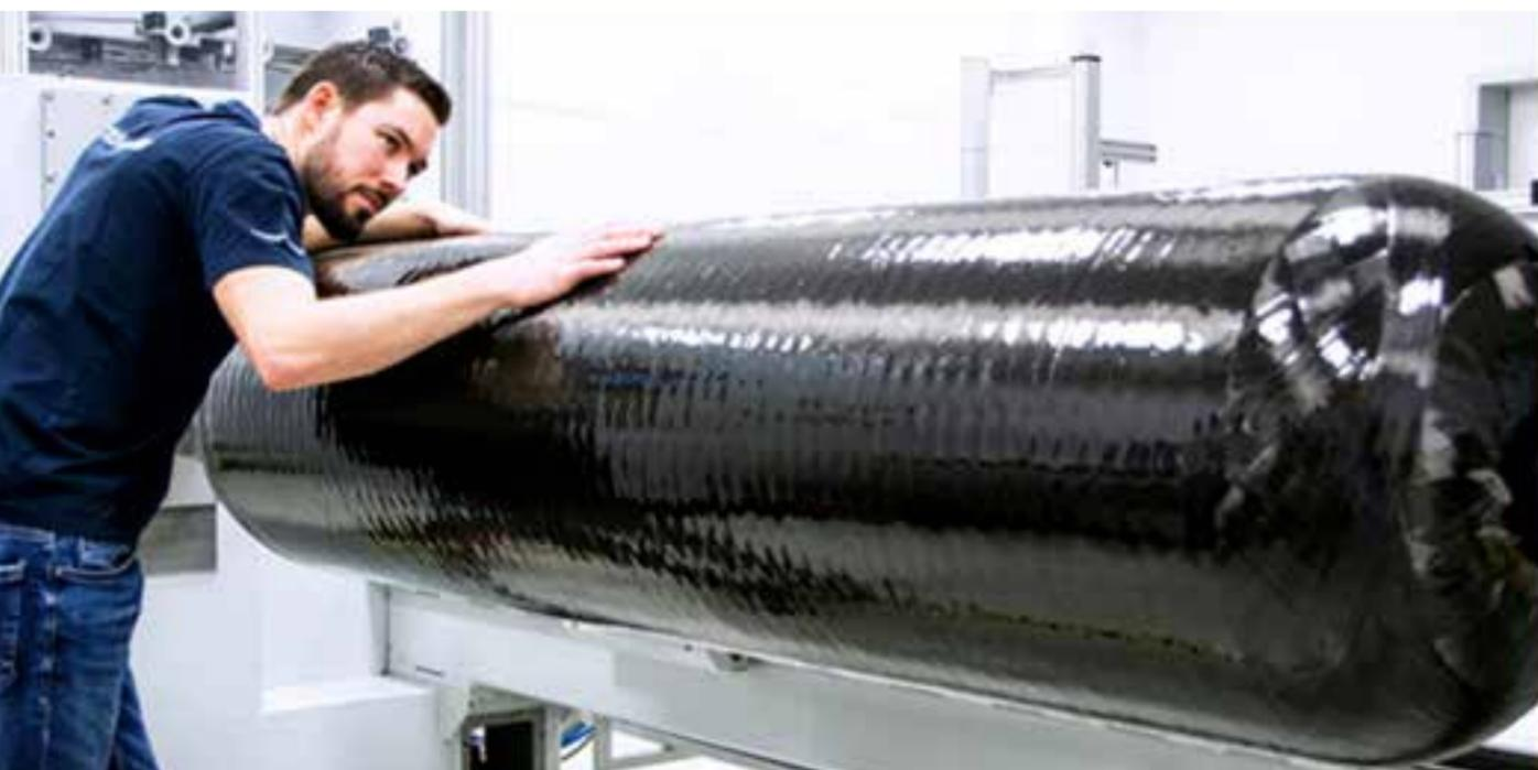
• 320 litros para hidrógeno. Los expertos en soplado de Kautex Maschinenbau han conseguido fabricar un cilindro revestido de poliamida de gran tamaño para recipientes de presión de hidrógeno con el proceso de extrusión por soplado.
