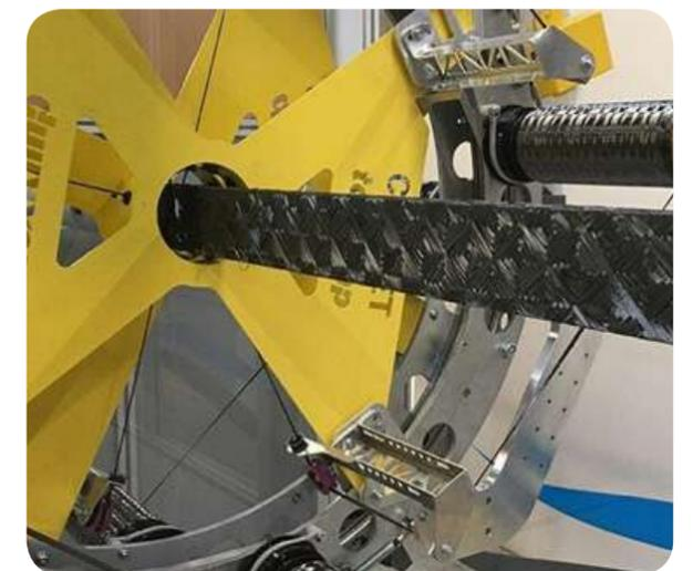
La 3D Winder es una máquina de bobinado multiteje de alta velocidad montada en un robot. Lanzada en 2018, es la primera tecnología de bobinado de este tipo capaz de colocar volúmenes muy altos de fibra de forma rápida y precisa para fabricar componentes complejos y curvos de composite que sean resistentes y repetibles.
