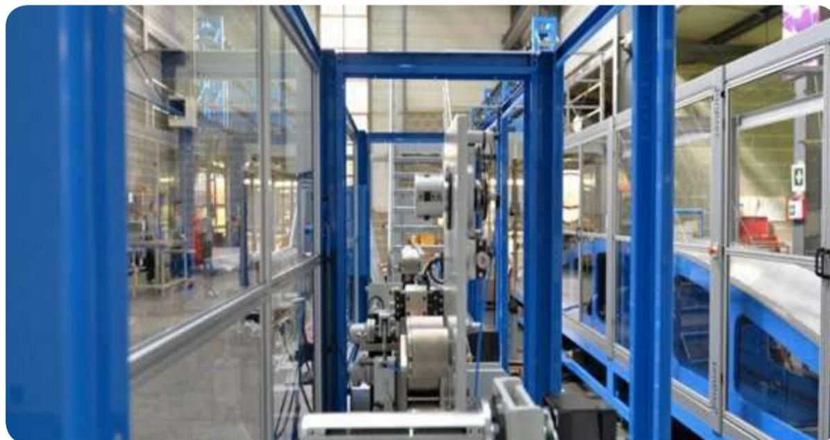
para ArianeGroup. Esta máquina permite el bobinado de materiales compuestos en una herramienta giratoria, así como el mecanizado de la pieza bobinada.
