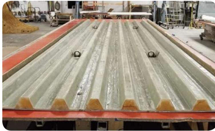
El puente, que se instala en el lugar, disminuye el tiempo de instalación y reduce los costes de energía y de construcción. El puente tiene una vida útil de 100 años. Con 16 pies de largo y 25 pies de ancho, el puente está diseñado para el tráfico forestal rural y las cargas pesadas.
