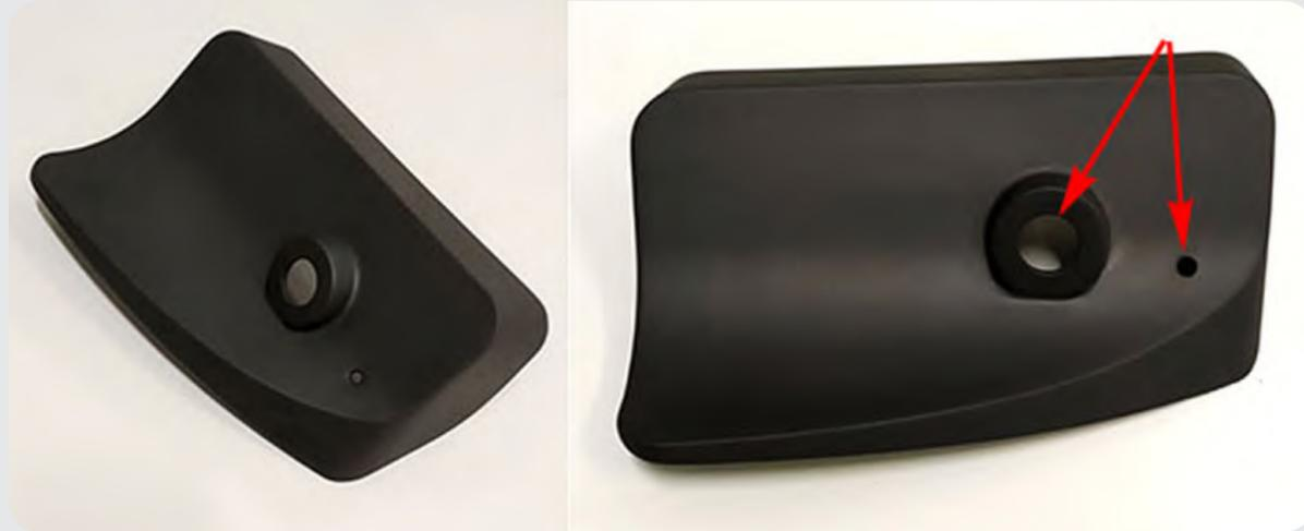
• Desde la izquierda, imágenes 1 y 2: cubierta del motor de arranque de los limpiaparabrisas en Windform XT 2.0, parte delantera. Las flechas rojas indican los orificios para la colocación del brazo del limpiaparabrisas y para la manguera de agua
