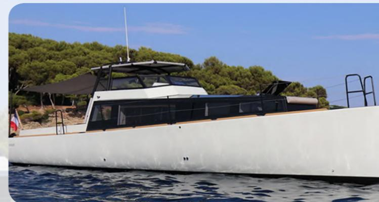
Hull. Ofrece la ventaja de una conducción más suave que cualquier casco de planificación convencional y una velocidad de crucero superior a la de cualquier barco de desplazamiento o semidesplazamiento. Con una velocidad máxima superior a los 20 nudos, cuenta con más de 400 millas náuticas de autonomía a una velocidad de crucero perfecta de entre 12 y 15 nudos
