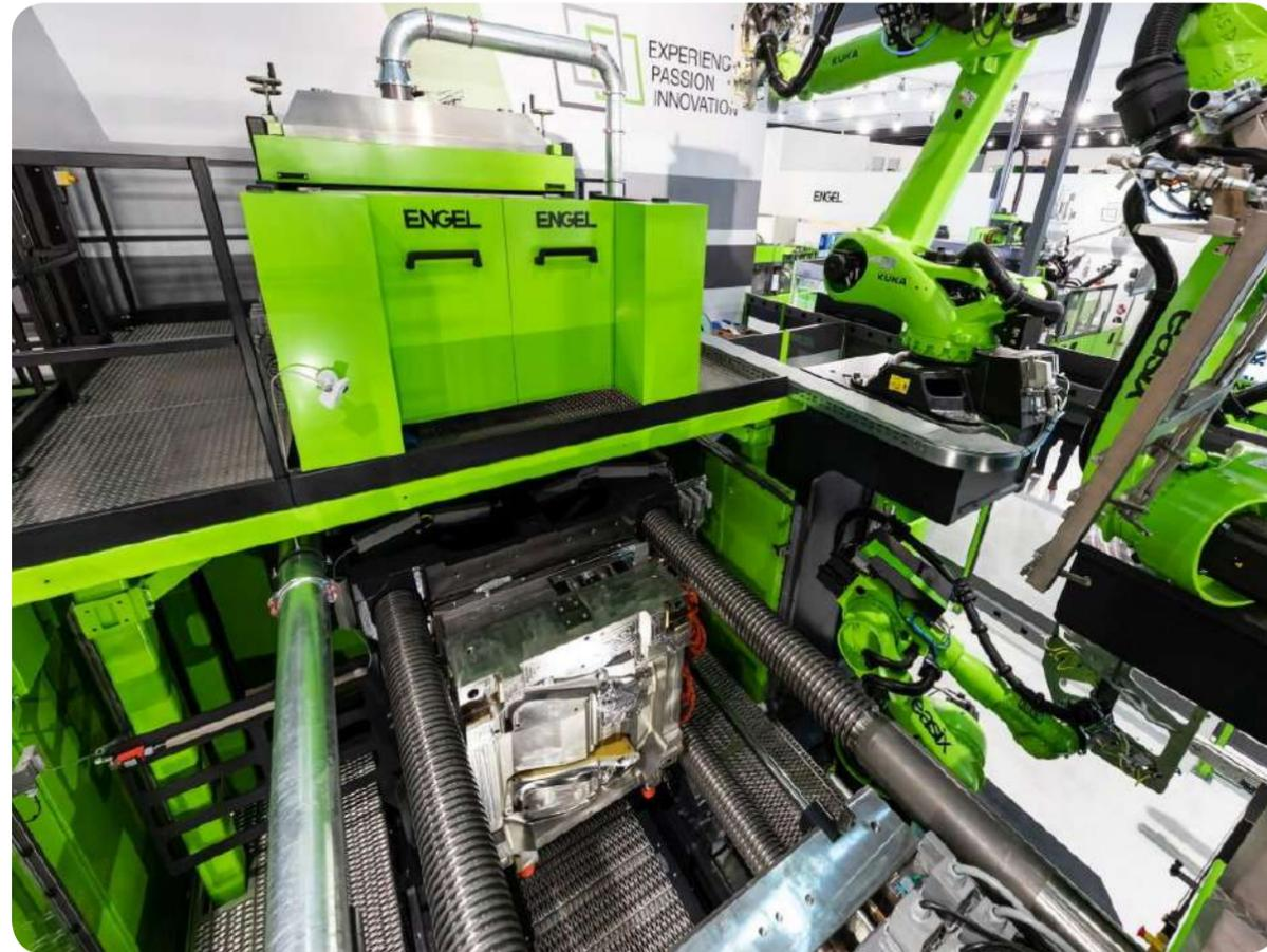
• Para la producción de los moldes de las puertas, se calientan, conforman y acondicionan tres chapas orgánicas de diferentes grosores y formas en un proceso de moldeo por inyección totalmente automatizado.
