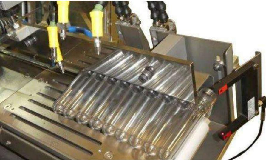
verizado en el PCS, solo se recubre el cuerpo de la preforma. Hay una protección en la zona del cuello de la preforma que previene la entrada de agente de recubrimiento, evitando así que se contamine el interior de la preforma.
