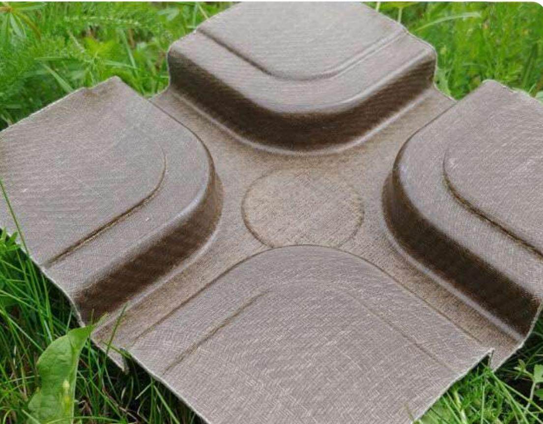
parable a la de las variantes equivalentes de material reforzado con fibra de vidrio. El diseño de los componentes compuestos para adaptarse a las cargas esperadas permite que la mayor parte de la fuerza se transfiera a través de las fibras continuas. Según Seidel, “Esto asegura que se logre la alta resistencia y rigidez características de los plásticos reforzados con fibra”.
