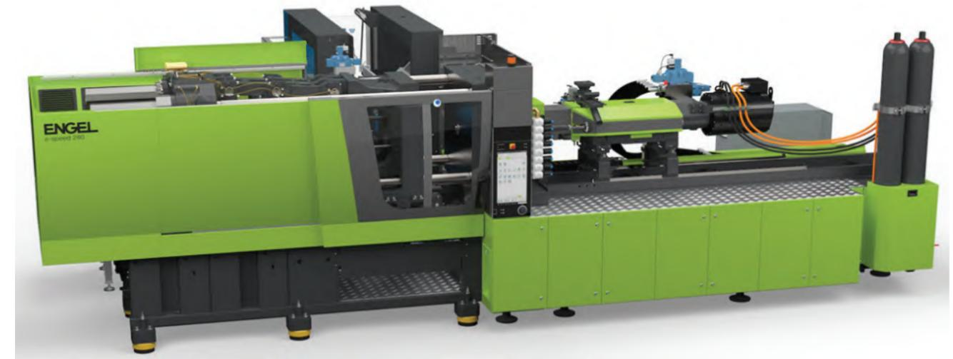
*Gracias a la nueva unidad de inyección de alto rendimiento, en la máquina de moldeo por inyección ENGEL e-speed se pueden producir envases de paredes finas de PET y rPET.*
