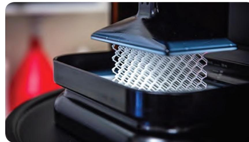
Por un lado, la tecnología de estereolitografía (SLA) utiliza un láser que solidifica capa a capa la resina ubicada en el tanque de la impresora 3D. Una vez se termina de trazar la capa, la placa de impresión desciende de nuevo para dar paso a la siguiente. Así, el proceso se repite hasta conseguir la pieza final. Por otro lado, la denominada Masked
