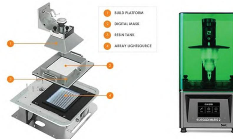
Stereolithography Apparatus (MSLA) es una forma modificada de impresión 3D SLA. A pesar de basarse en el mismo principio de fotocurado de la resina gracias a una fuente de luz, el método es algo diferente. Concretamente, en lugar de utilizar un rayo láser para trazar las capas, las impresoras MSLA
