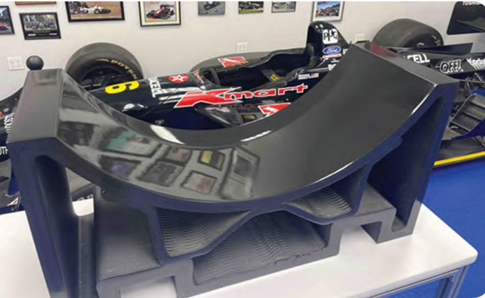
inspección de piezas y análisis microscópico. Estas pruebas posteriores al autoclave confirmaron que la herramienta de composite impresa en 3D podía soportar la presión del autoclave y las tensiones térmicas durante 500 ciclos. Airtech escribe sobre el reciente hito de las pruebas: "Se han iniciado varios programas de desarrollo debido al éxito en la fabricación de herramientas para autoclave, pero su objetivo era la producción de prototipos limitados."
