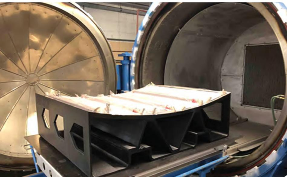
sustancial (la pieza final mide 4,3 x 2 metros). “La herramienta muy compleja realmente destaca cómo puede cambiar el diseño de la herramienta para ayudar a aligerar la estructura”, dice Zach Skelton, ingeniero sénior de soporte técnico de Airtech.
