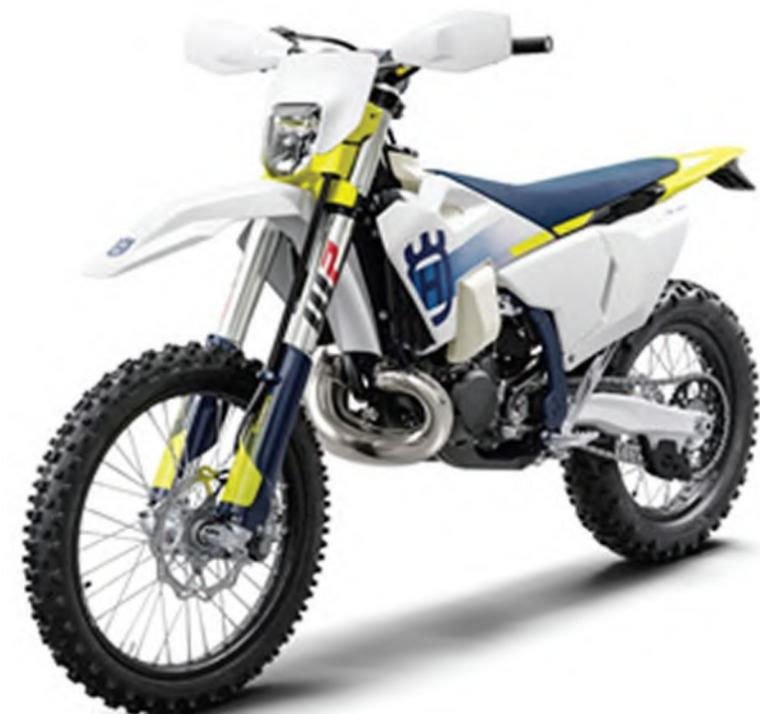
Este modelo está equipado con un sistema de arranque eléctrico de serie, el cual utiliza una batería de iones de litio 1 kg más liviana que una de tipo convencional. Con varios años de experiencia en el desarrollo y perfeccionamiento del arranque eléctrico, garantiza la confiabilidad de los modelos en-
