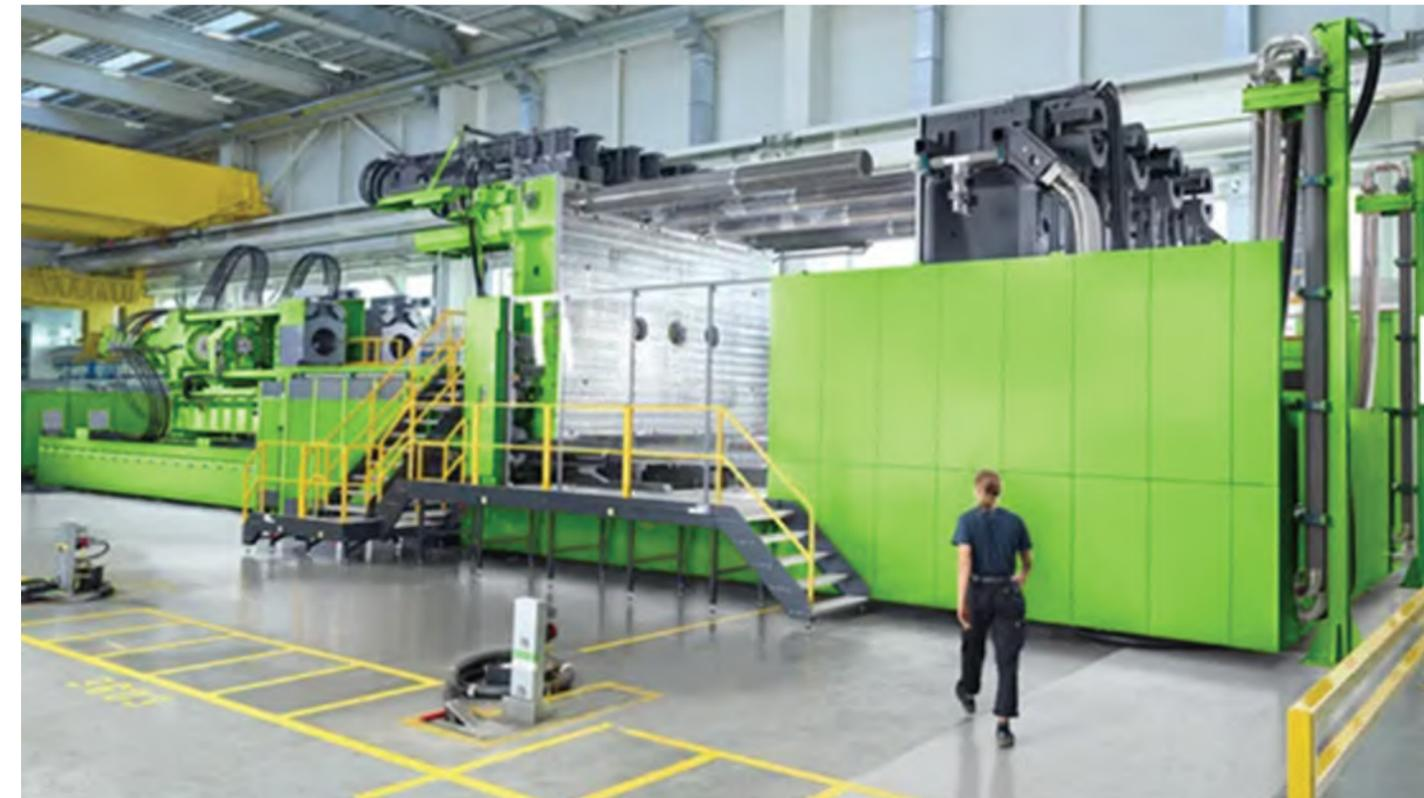
• Para las nuevas aplicaciones en movilidad se precisan, en ocasiones, máquinas de moldeo por inyección particularmente grandes. ENGEL construye megamáquinas con fuerzas de cierre de más de 10.000 toneladas. (Imagen: ENGEL)
