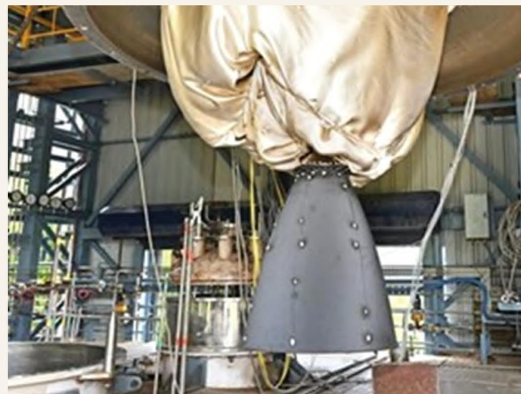
● *Boquilla compuesta C/C conectada al motor PS4. Fuente de las imágenes: ISRO*
