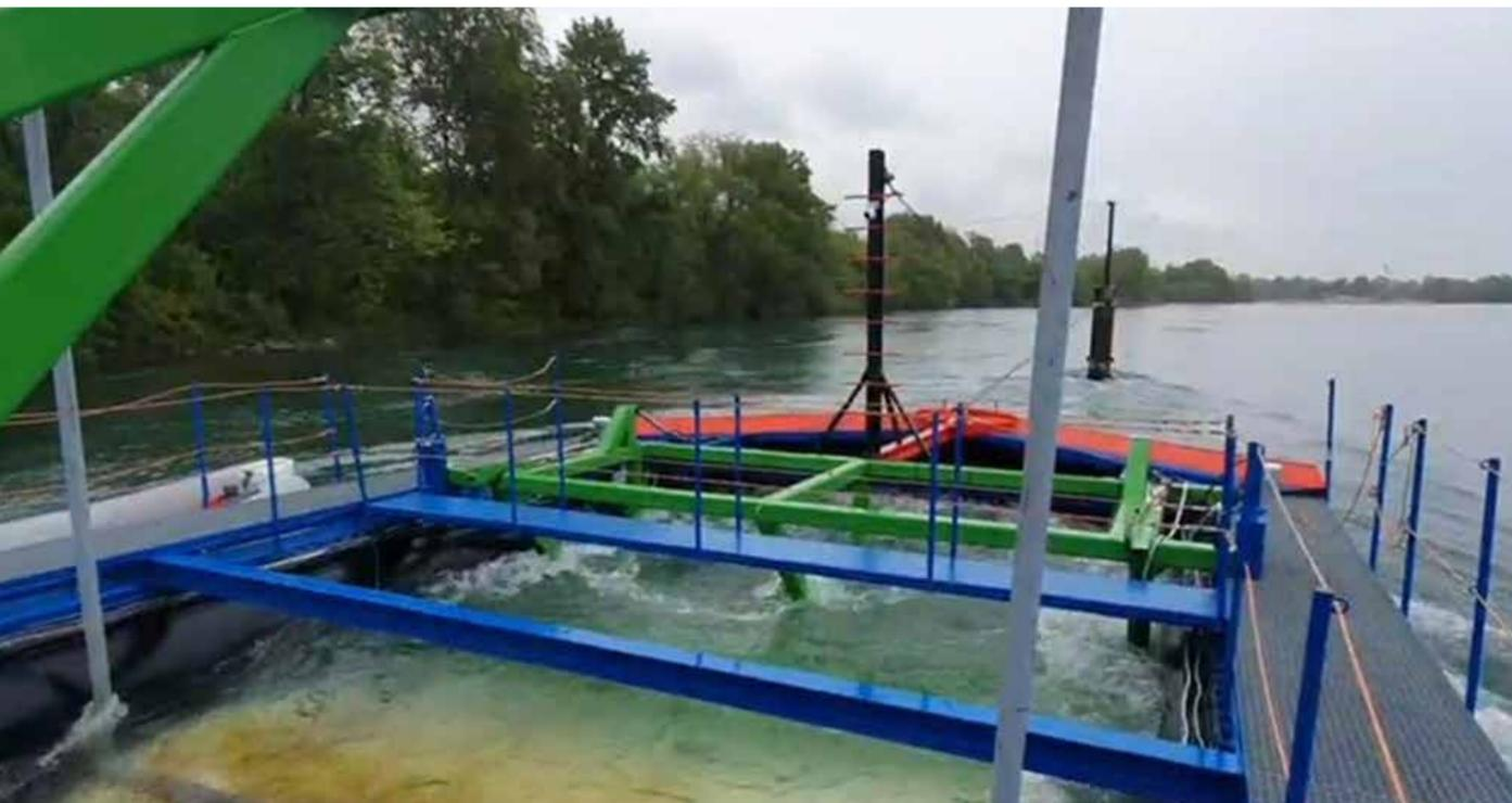
funcionando como una bomba que genera un flujo similar al del corazón humano. Esta tecnología ha demostrado su eficacia en dispositivos médicos y es adaptable para su uso en la generación de energías renovables. Los vórtices creados por el flujo turbulento en el agua pueden ser capturados por una membrana flexible, y el movimiento ondulado puede utilizarse para impulsar un generador eléctrico.
