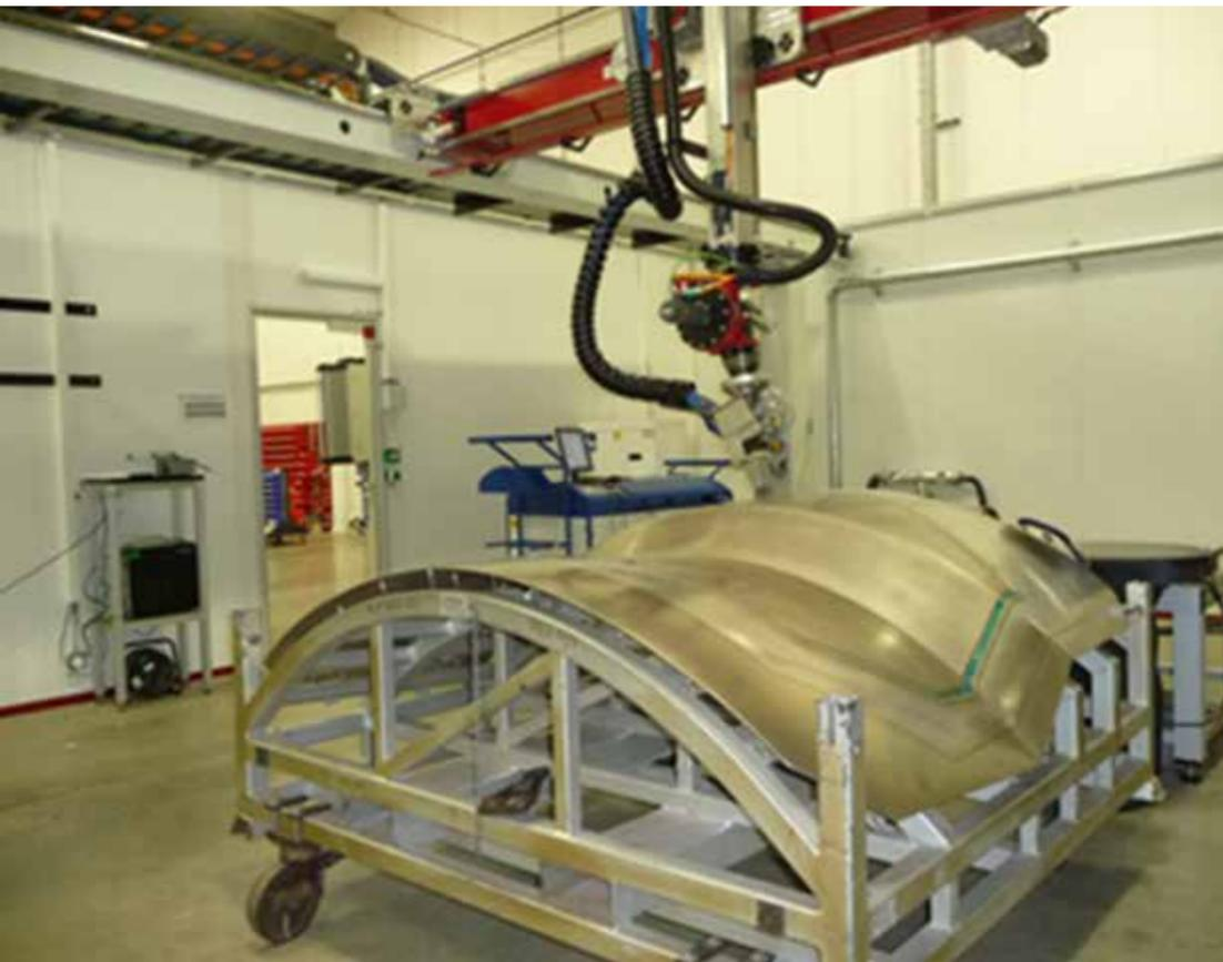
perfiles de superficie complejos a velocidades de hasta 22 metros cuadrados/hora para ciertas aplicaciones. La limpieza láser también se puede utilizar para preparar paneles de polímero reforzado con fibra de carbono (CFRP) para la unión adhesiva o diversas superficies de piezas para ensayos no destructivos.
