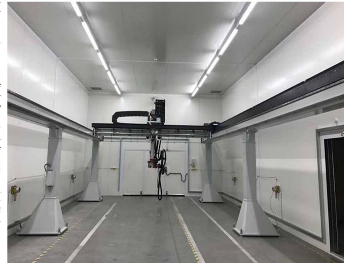
pacidad y larga vida útil. Los láseres de fibra continua se suelen elegir para trabajos a gran escala, como el decapado de pintura y revestimientos de grandes estructuras marinas para su preparación para inspecciones o reacondicionamientos, y para la limpieza de moldes y maquinaria de gran tamaño en plantas de fabricación. Estos láseres pulsados son ideales para la eliminación precisa de material, no solo para la inspección y la preparación para END, sino también para una limpieza suave.
