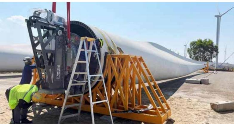
• *Mecanizado CNC de raíces de palas in situ. Fuente (Todas las imágenes) | We4Ce y CNC Onsite*
