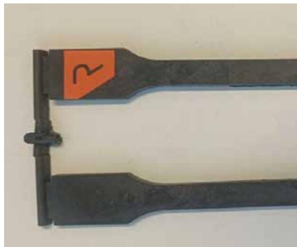
• Ejemplos de compuesto termoplástico vs. compuesto termoplástico reciclado. El proyecto Rein4ced comenzó con el moldeo por inyección de muestras fabricadas con rCFRTP frente a CFRTP virgen para comparar las propiedades mecánicas. Fuente | Rein4ced
