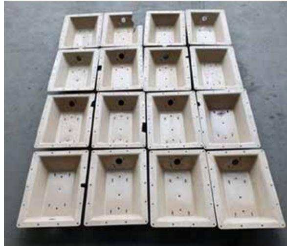
• *Placa de detector de humo de material compuesto Spiral RTC está trabajando para lograr el reciclaje eficiente de piezas al final de su vida útil (EOL), incluyendo este lote de placas de detector de humo de PRFV. Fuente | Spiral RTC*
