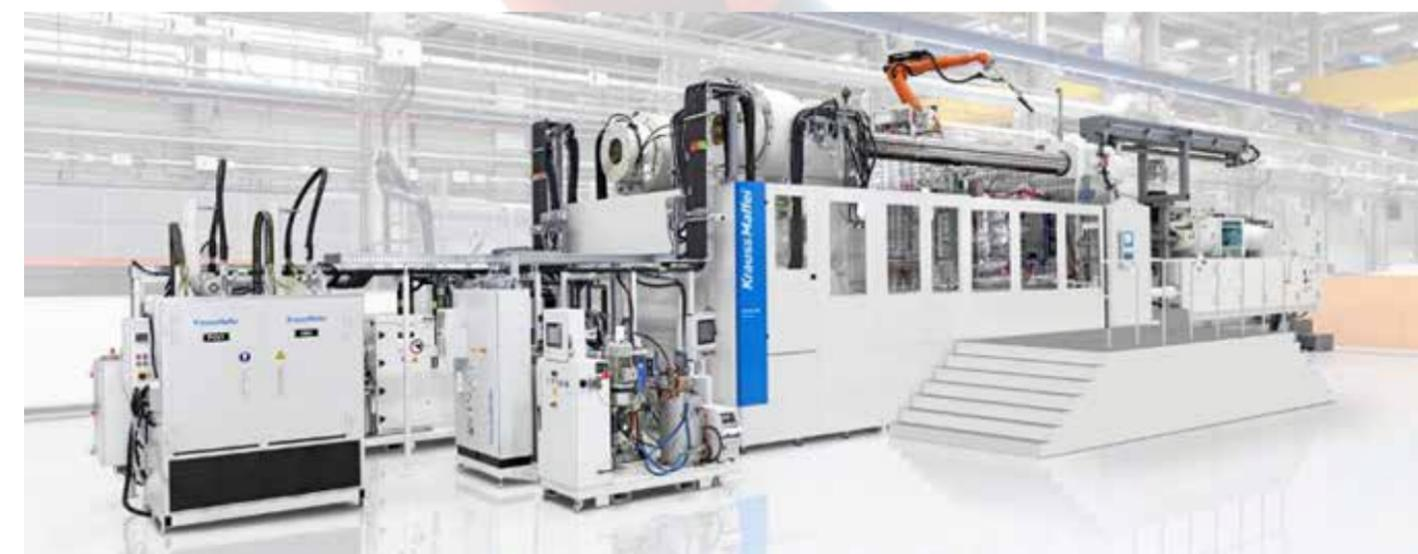
Como el PC amarillea debido a la radiación UV y los faros están expuestos a impactos de piedras y tensiones similares, al componente se le aplica su recubrimiento de poliuretano transparente directamente en el molde.
