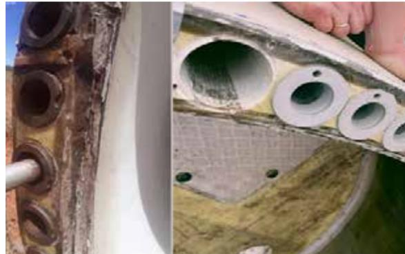
Antes de las reparaciones (izquierda) y después de la instalación del buje (derecha)
