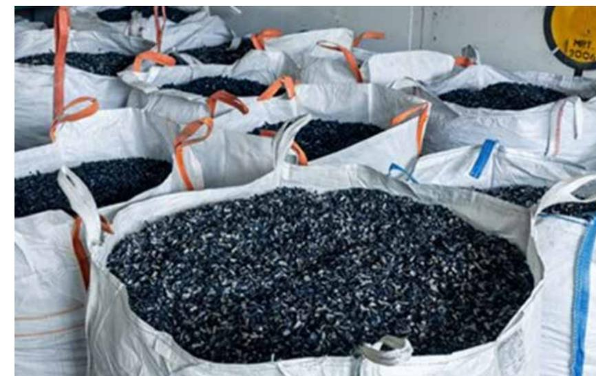
• *El remolido de TPC de grado aeroespacial se envía a un socio fabricante de compuestos para su procesamiento en pellets de moldeo por inyección. Fuente | RTC Espiral*
