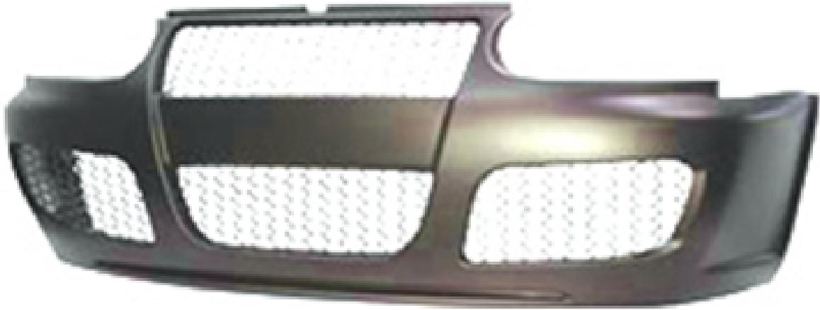
*el material más utilizado es el PP (polipropileno) que representa casi un 30% en peso, lo sigue el caucho en los neumáticos, luego los polímeros de ingeniería y elastómeros varios. A modo de ejemplo, se puede destacar el uso del PP ya que ofrece una alta resistencia química, una resistencia al calor mayor que la de otros materiales como el PE (polietileno), buena resistencia mecánica y eléctrica y la posibilidad de incorporar cargas, como son el negro de humo y diversas fibras.*
