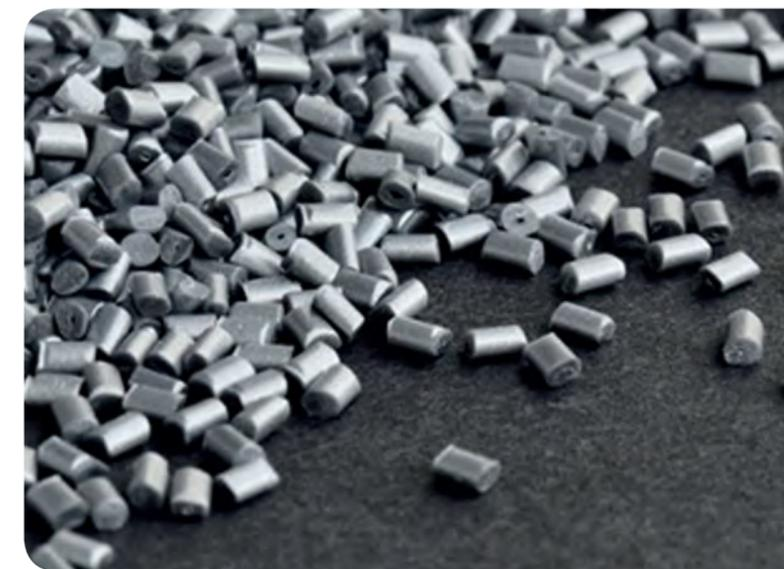
hacen valioso en diversos sectores. La gran resistencia mecánica y rigidez del PESU lo hacen adecuado para aplicaciones que requieren integridad estructural y capacidad de carga.
