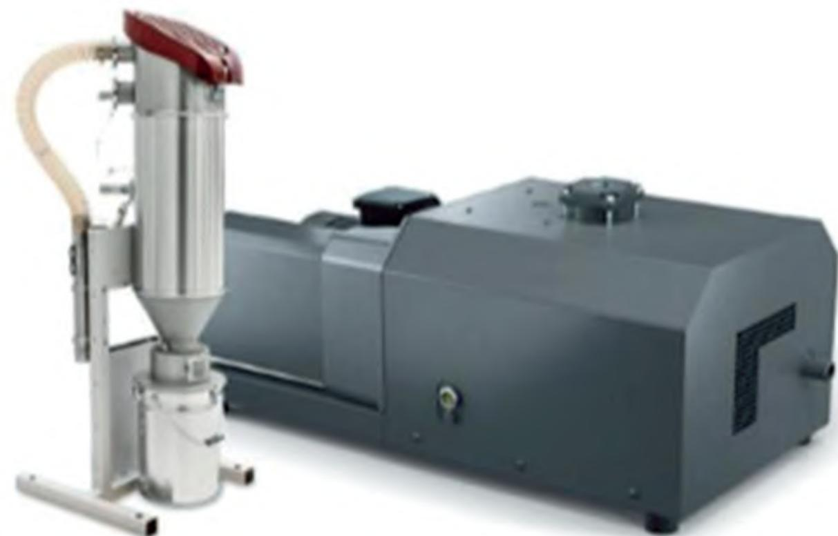
Bomba de vacío (al fondo) y estación de filtrado XMB.
