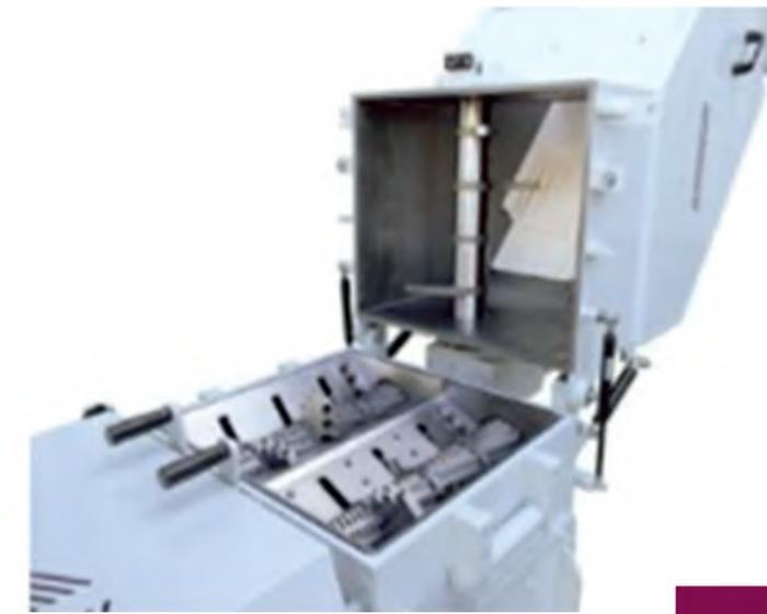
Cámara de corte con el eje de alimentación adicional en la parte giratoria de la tolva de material.
