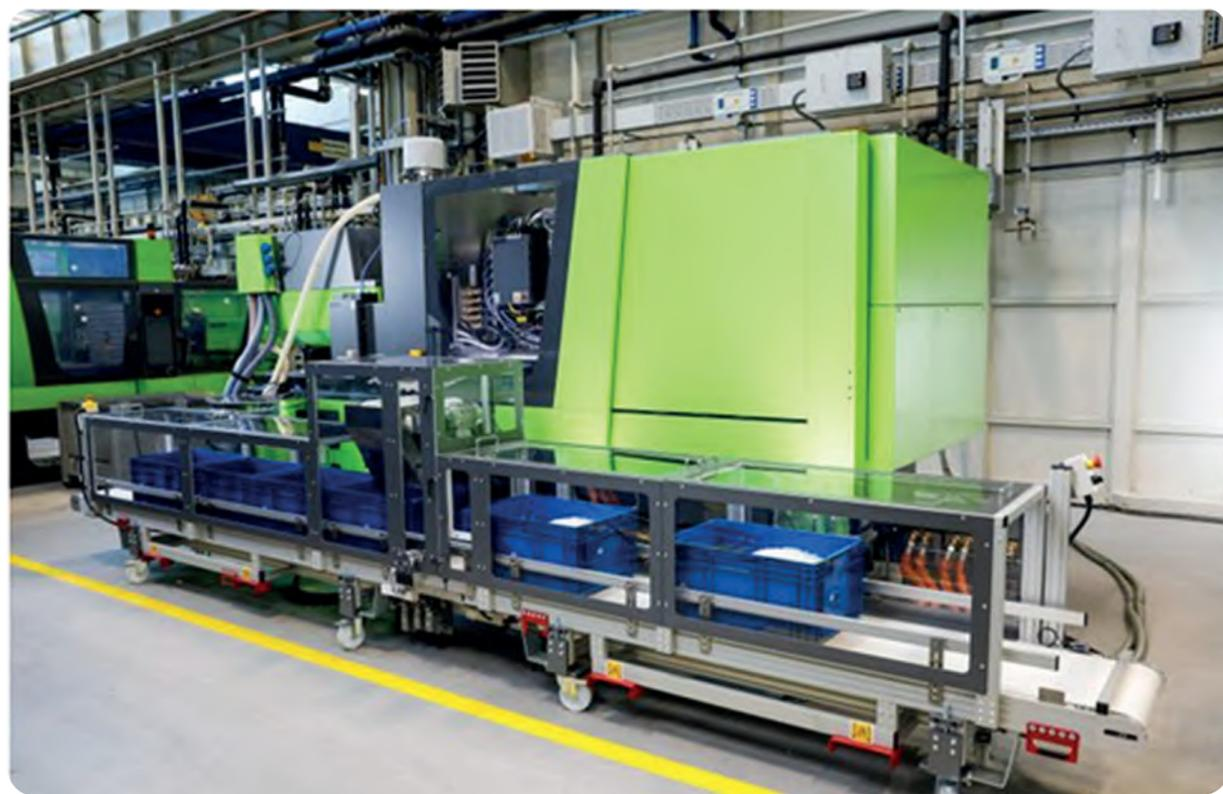
El sistema de transferencia de cajas ofrece una conectividad óptima para una producción semiautomatizada. Imágenes: ENGEL
